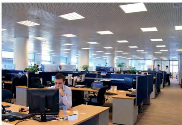
Светильники CSVТ Belluce монтируются в подвесной потолок типа «ГРИЛЬЯТО». Отражатель крепится к корпусу светильника при помощи скрытых металлических пружин.
