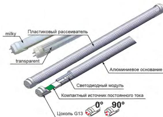
Корпус лампы T8-LED-CSVT-DR имеет алюминиевое основание и пластиковый рассеиватель двух видов светопропускания: молочный – MILKY и прозрачный – TRANSPARENT.
