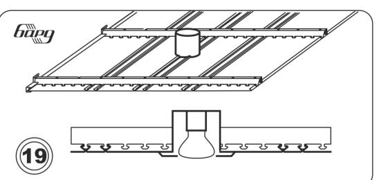
Светильник может устанавливаться и в две панели. Полукругности в каждой из двух панелей вырезаются таким же способом.
