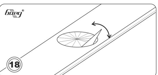
Врезка светильников R50. На панели (или на двух) вырезается окружность ножом по шаблону. После очерчивания окружности ножницами от центра к краям вырезаются сектора. Далее, чтобы избежать коробления панели, каждый из секторов отгибаётся и отламывается. Чем больше секторов, тем ровнее получится вырезанный круг.
