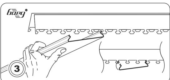
Установка первой панели. Панель с незначительным усилием (нажатие на край панели) защелкнуть на стингере. Панель предварительно укоротить на 3-5 мм от реального размера помещения.
