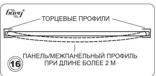
Установка последней панели в потолке. 1-й способ: при длине панели более 2 м, завести один край панели в торцевой профиль до упора, немного согнуть ее из плоскости вниз и вставить в торцевой профиль у противоположной стены.
