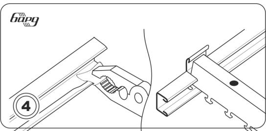
Углы нижней полки торцевого профиля поджать пассатижами через мягкую прокладку 1.5 см. Верхнюю полку в местах сопряжения со стингерами подрезать и отогнуть наверх
