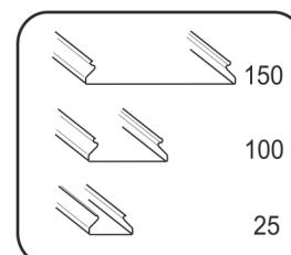
Панель и межпанельный профиль изготовлены из специального сплава и покрыты бесцветным лаком для повышения коррозийной стойкости. Декоративное покрытие - эмаль.
