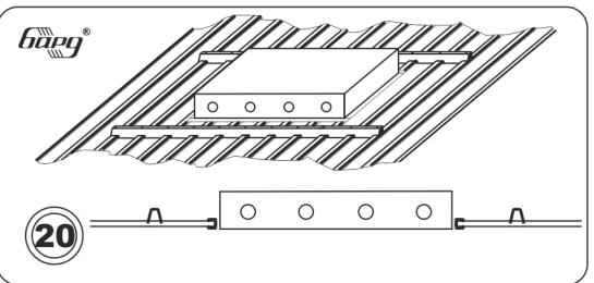
Установка светильника 600x600. Необходимо обеспечить зазор между панелью и светильником - панель не ставить враспор, она должна свободно располагаться на посадочном месте
