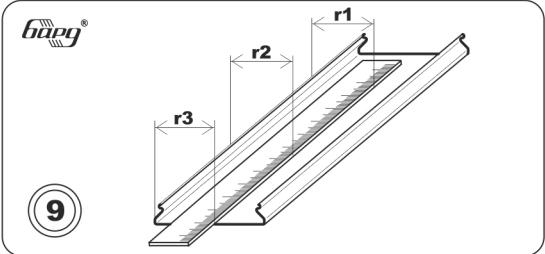
На очередной панели отложить эти расстояния и разметить панель для резки.
