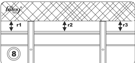
Произвести замеры расстояний от первой панели с межпанельным профилем до стены для установки резаной панели.
