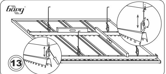
Регулировка высоты производится передвижением регулировочных пружин по спицам или с помощью саморезов (глубиной ввинчивания саморезов). Контроль производится водянным уровнем. На этом этапе важно сразу сделать разметку на панелях под светильники, чтобы не забыть об этом во время набора панелей.
