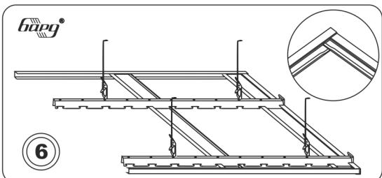
Установить два торцевых профиля, перпендикулярных первой панели. Установить еще одну или несколько панелей равномерно по всей длине стингеров.
