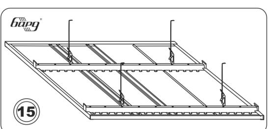
Установка оставшихся панелей. Все панели монтируются также как показано выше, кроме последней (или последних двух панелей). Межпанельные профили устанавливаются по мере монтажа панелей
