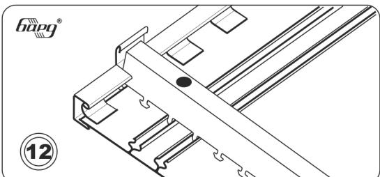
Установить резаную панель с надетым на нее торцевым профилем.
