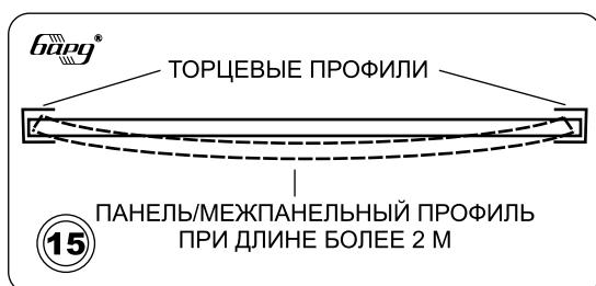
Установка последней панели в потолке. 1-й способ: при длине панели более 2 м, завести один край панели в торцевой профиль до упора, немного согнуть ее из плоскости вниз и вставить в торцевой профиль у противоположной стены.
