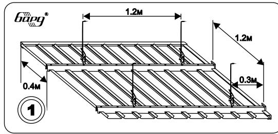
Максимальные размеры для разметки потолка. Стингеры должны быть установлены строго параллельно друг к другу
