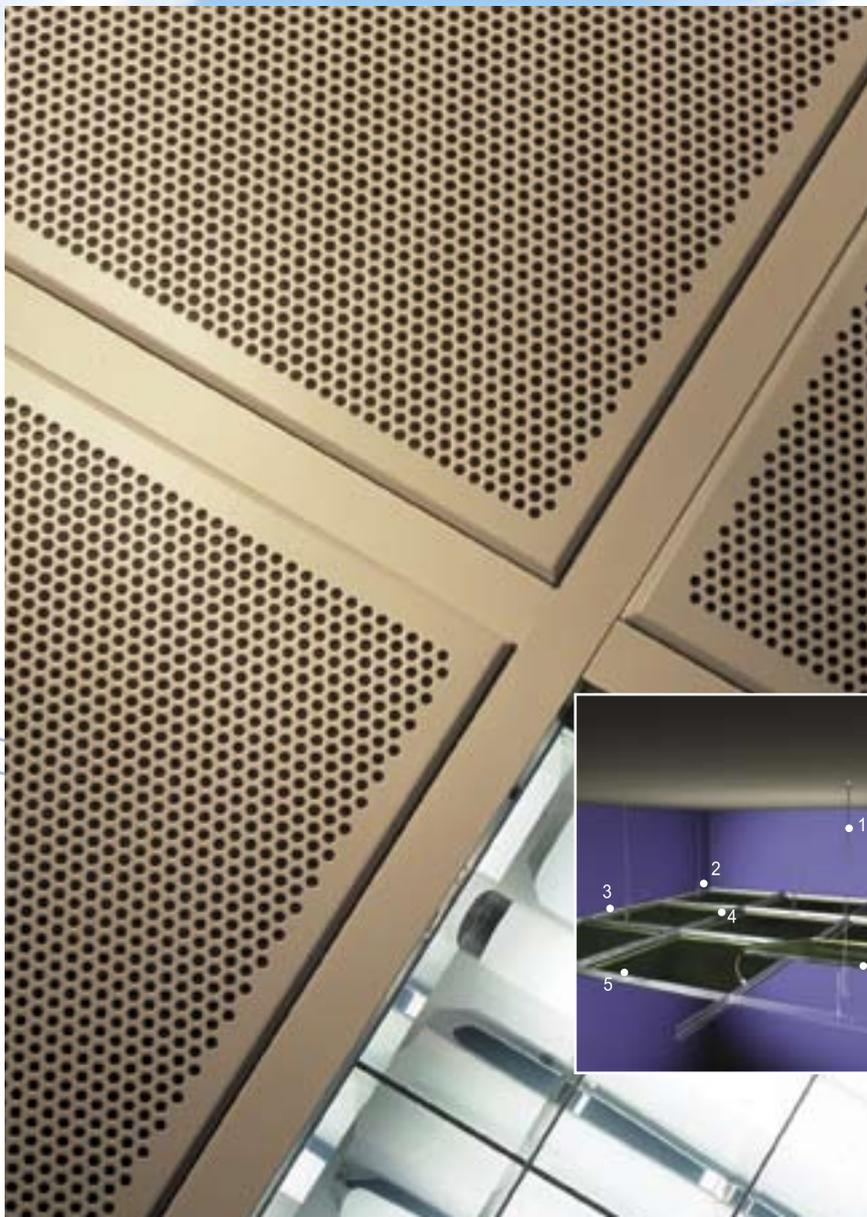
Квадратные кассеты для вкладывания в подвесные конструкции с Т-профилями могут быть поставлены для варианта, когда кассеты расположены ниже подвесного профиля, для варианта, когда кассеты укладываются на подвесную систему и для варианта, когда кассеты крепятся на одном уровне с подвесной системой.
