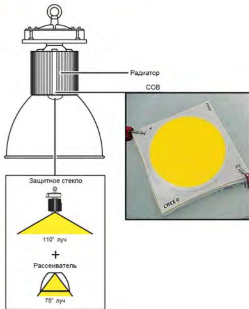
Излучающий модуль светильников СОВ-PR-CSVT выполнен по технологии COB (Chip-on-Board – чип на плате).
