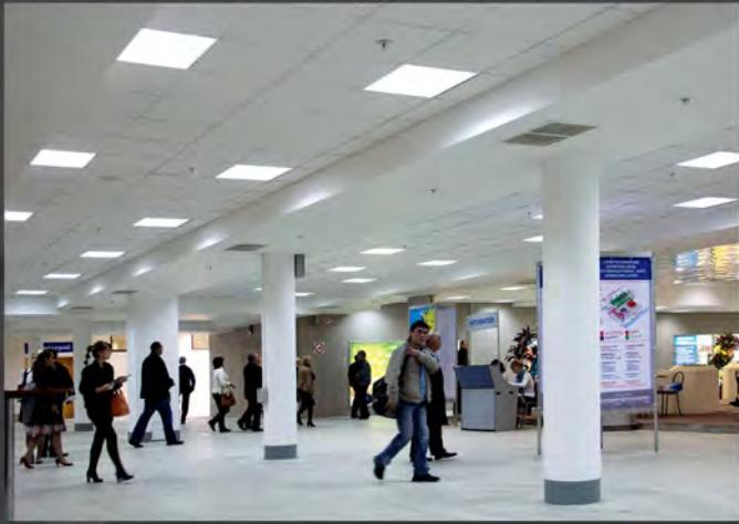
Светильники CSVT Operlux 595x595 монтируются в подвесные потолки типа «Армстронг». Светильники комплектуются пластиковым рассеивателем ice или рассеивателем в металлической рамке ice/R.
