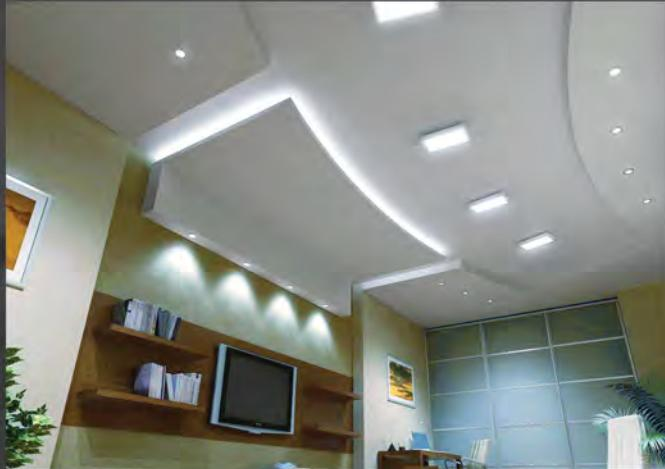
Светильники накладные CSVT Operlux монтируются на поверхность потолка. Светильники комплектуются пластиковым рассеивателем opal/R. Рассеиватель крепится к корпусу светильника при помощи скрытых металлических пружин.
