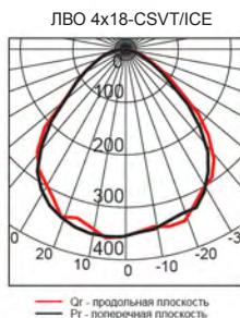
Светильники ЛВО 4x18-CSVT 595x595 монтируются в подвесные потолки типа «Армстронг». Светильники комплектуются пластиковым рассеивателем ICE или рассеивателем в металлической рамке ICE-R.
