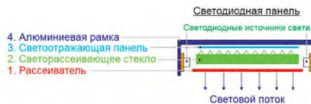
Светильники предназначены для работы в сети переменного тока с номинальным напряжением 220 В±10 %, частоты 50-60 Гц. Устойчивость к механическим воздействиям по группе М1 по ГОСТ Р 17516.1-90.
