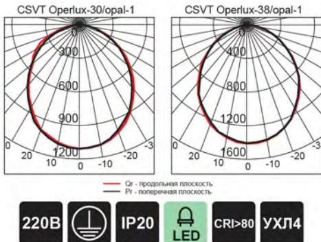
Светильники CSVT Operlux 595x595 монтируются в подвесные потолки типа «Армстронг». Светильники комплектуются пластиковым рассеивателем opal или рассеивателем в металлической рамке opal/R.
